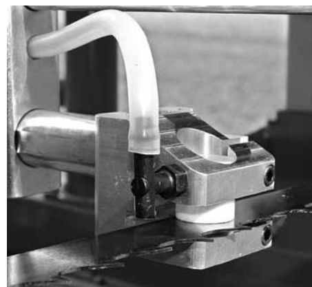
Steinhart: Keramikführungen für das Sägeblatt
